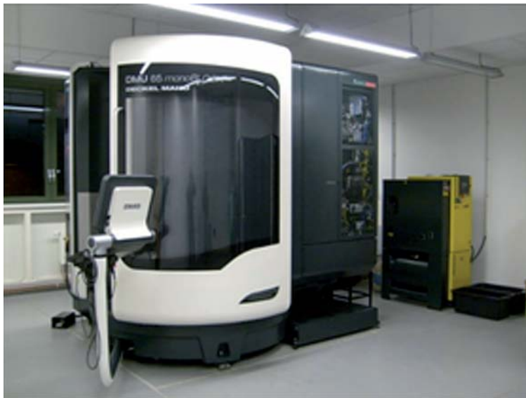
Obr. 5 – Pětiosé CNC frézovací centrum DMU 65 MonoBlock
